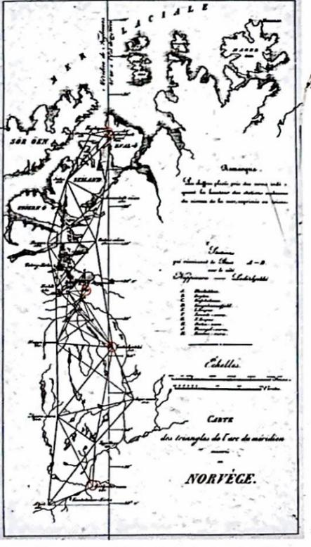
Figure / Figur 6: Map of Norwegian stations measured in the original Struve Geodetic Arc. The four stations are marked with red circles. Die Karte zeigt alle norwegischen Messpunkte auf dem Struve-Meridianbogen. Die vier Messpunkte auf der UNESCO-Liste sind jeweils mit einem roten Kreis markiert.
