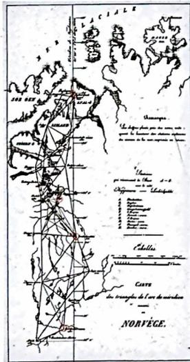
Figure / Fig 5: Map of Norwegian stations measured in the original Struve Geodetic Arc. The four stations are marked with red circles. Die Karte zeigt alle norwegischen Messpunkte auf dem Struve-Meridianbogen. Die vier Messpunkte auf dem Struve-Meridianbogen vom Schwarzen Meer bis nach Hammerfest. Liste sind jeweils mit einem roten Kreis markiert
